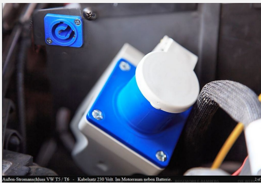
Außen-Stromanschluss VW T5 / T6 - Kabelsatz 230 Volt Im Motorraum neben Batterie
