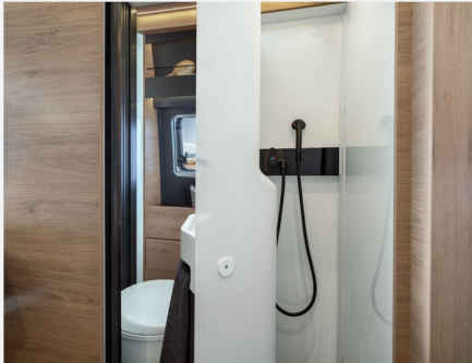
Schwenkwandbad, kompakt, mit ausziehbarem Waschbecken
