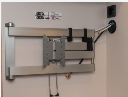
TV-Vorbereitung mit Steckdose und Kabelverlegung/-durchführung
