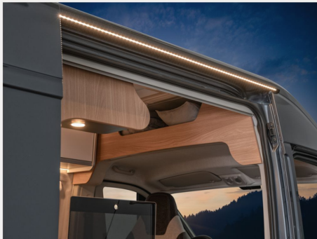
Regenrinne über der Schiebetür mit LED (dimmbar)
