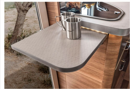
Klappbare Arbeitsplattenverlängerung. Die praktische Verlängerung mit Einhandbedienung schafft zusätzliche Arbeitsfläche.
