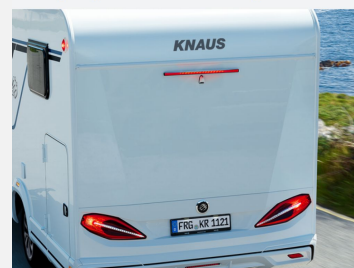
FoldXpand Heckkonzept: Vollplastische Heckwand mit bündig integriertem Heckleuchtenträger
