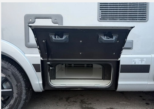
doppelter Boden / Fußbodenheizung (ALDE)
